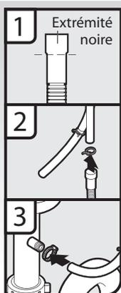
1. Connecter l'extrémité noire du tuyau d'évacuation sur le brise-vide; couper si nécessaire (ne pas couper dans la section ondulée).
